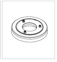
Assurez-vous que les brosses/ tampon d'entraînement sont propres et non usés. Remplacez-les si nécessaire.
