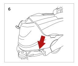
Tournez la valve manuellement pour ajuster le niveau de l'eau.
