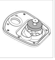
Assurez-vous que le sceau extérieur Assurez-vous que le filtre de sortie des couvercles est propre et non endommagé. Remplacez-le si nécessaire.
