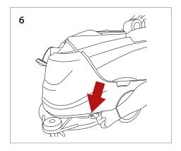
Tournez la valve manuellement pour ajuster le niveau de l'eau.
