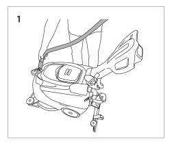
Ajouter de l'eau et un produit chimique dans le réservoir.
