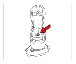
Assurez-vous que le filtre de remplissage du réservoir du détergent est intact et propre.
