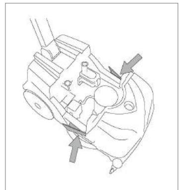
Appuyez sur les loquets latéraux pour retirer et vider le réservoir de solution.
