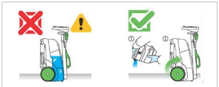
Videz les réservoirs avant de stocker la machine à la verticale.
