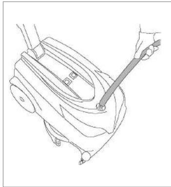
Remplissez le réservoir de solution avec de l'eau et du détergent.
