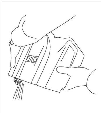
Retirez le réservoir de récupération de la machine pour le vider.
