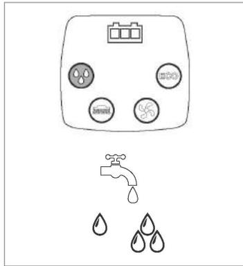
Appuyez sur le bouton de solution pour régler le niveau d'eau souhaité.
